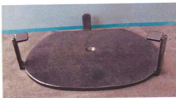
Socle après sablage et mise en peinture
